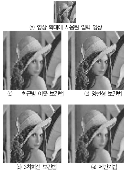
그림 9. 64x64 크기의 Lenna영상을 기존 방법 및 제안기법을 적용하여 가로축 방향 및 세로축 방향으로 각 4배 확대한 영상 Fig. 9. 4-times magnified images using the previous schemes and the proposed scheme
