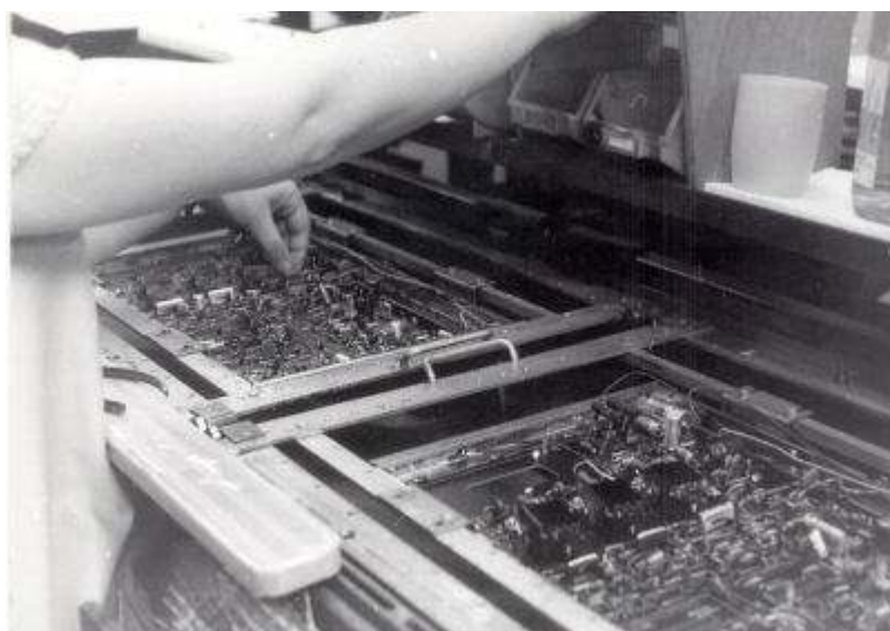
Figure 7. Un des modes opératoires " réels " au poste d'insertion sur la chaîne de montage électronique : mouvements simultanés
