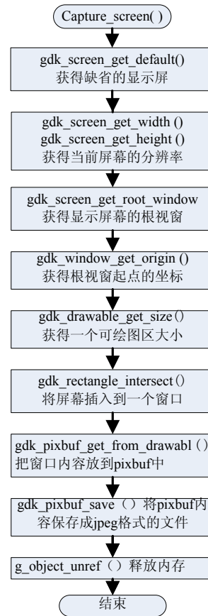
Figure 1. Flowchart: Screen capture module 图 1. 抓屏模块的流程图
