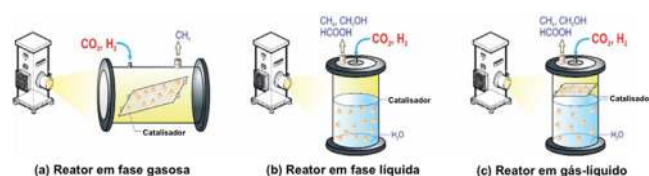
Figura 6. Três tipos de reatores: (a) reator em fase gasosa, (b) reator em fase líquida e (c) reator gás-líquido. Adaptado de Chen et al. 174
