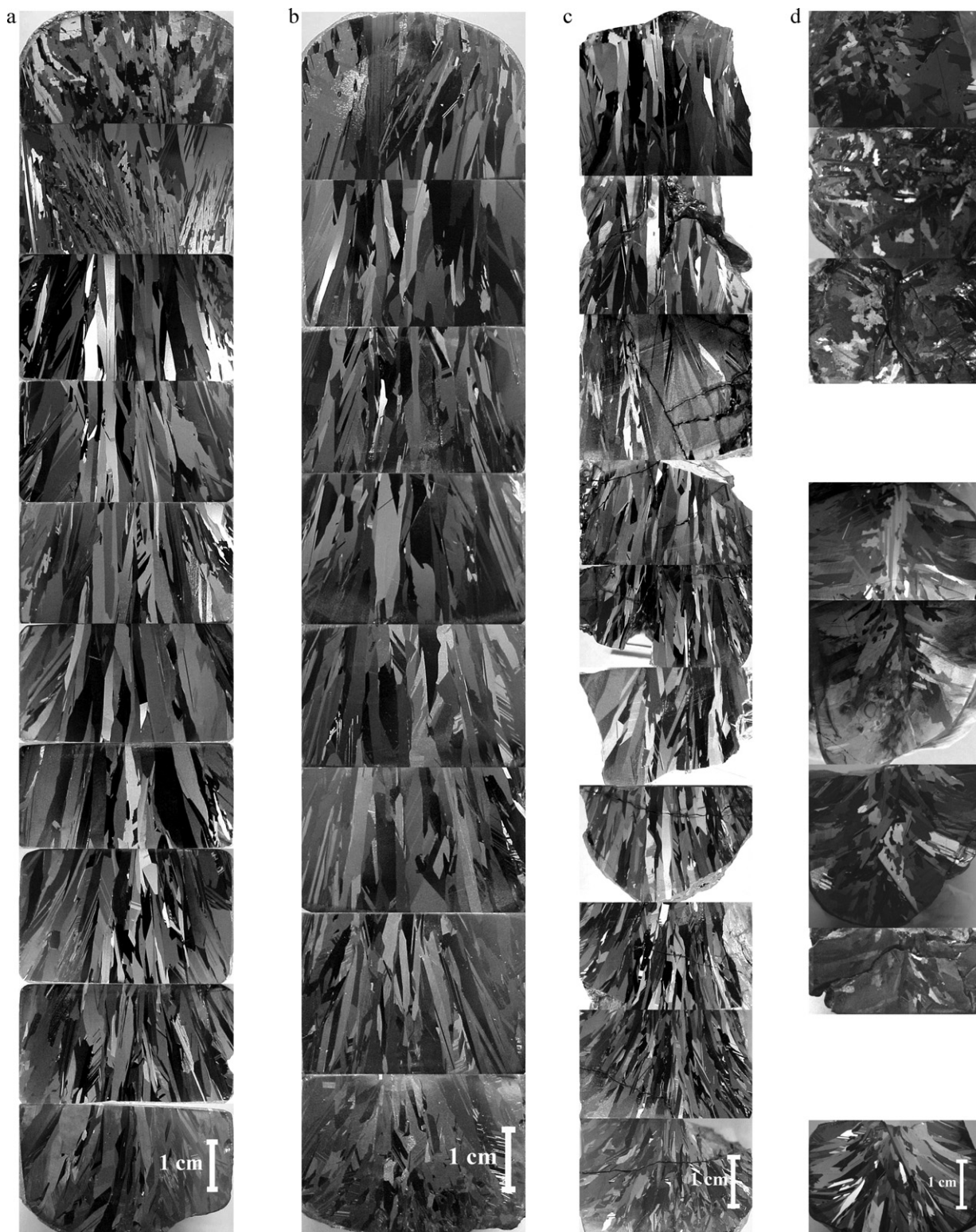
Fig. 2. Macrostructures of Si ingots: (a) MG-Si, V=5 \mu\text{m s}^{-1} ; (b) RMG-Si, V=5 \mu\text{m s}^{-1} ; (c) RMG-Si, V=20 \mu\text{m s}^{-1} ; (d) RMG-Si, V=110 \mu\text{m s}^{-1} .
