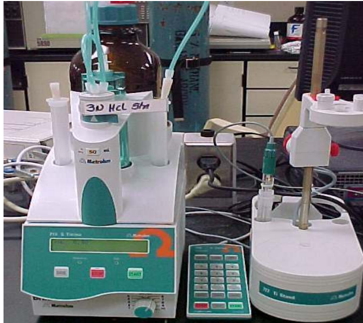
Figure 3-5. Auto-titrator 719 Titrino, Metrohm
