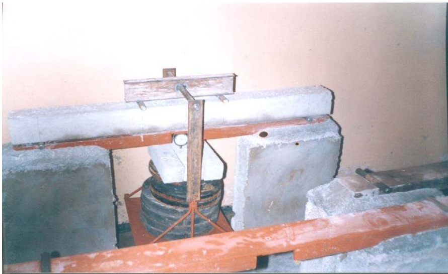
Fig. 5.1 : Schéma d'un bâti de fluage
