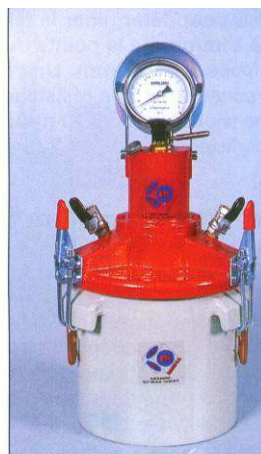
Fig.3.11: Aéromètre pour la mesure de L'aire occlus
