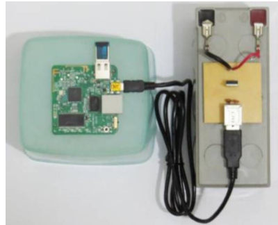
Fig. 4. Nodo alimentado por una batería externa
