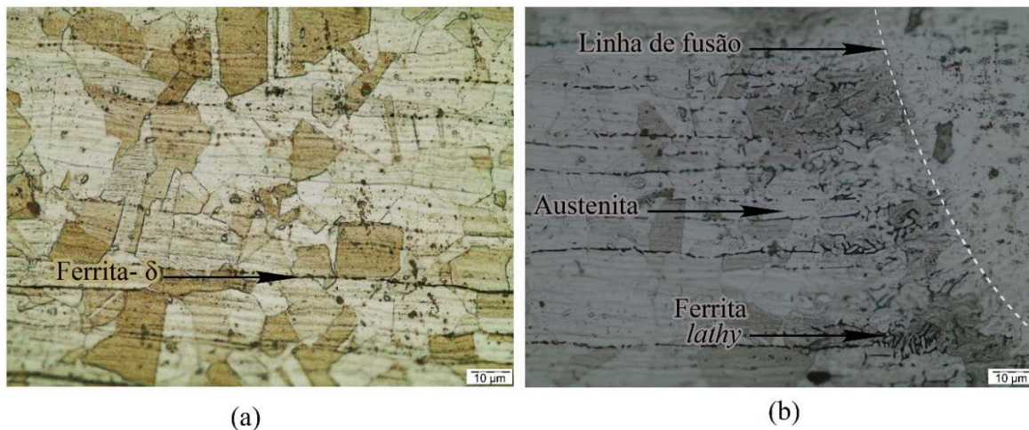
Figura 3. Micrografia do AISI 316L – Microscopia Ótica: (a) evidências de ferrita delta enfileiradas na austenita da amostra 0-50 – 500X e (b) presença de ferrita lathy na ZTA a partir da linha de fusão da amostra 0-50 - 500X.
