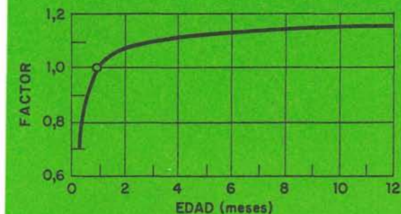
Factor de corrección para la resistencia del hormigón en función de la edad.
