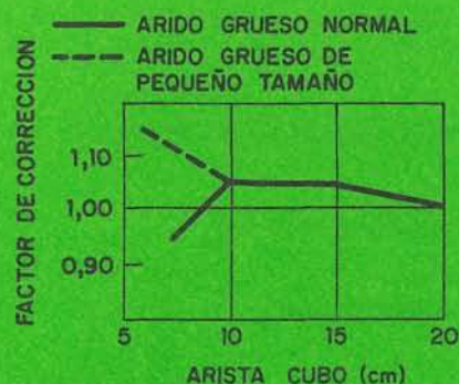
Corrección de resistencias en cubos en función de la arista.
