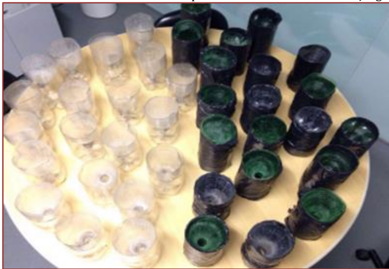
Figura 1: Armadilhas Mosquitérica, metade confeccionadas de acordo com a metodologia de Cabral na revista FAPERJ 2008 e metade revestidas com saco preto no Centro Universitário Jorge Amado
