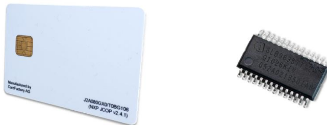
Abbildung 3-19: Security Token (links: Smartcard, rechts TPM)
