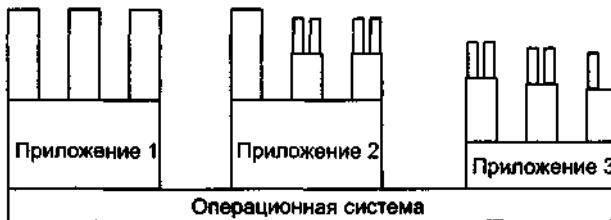
Рис. 10.2. Современная структура компонентно-ориентированного программного обеспечения
