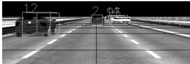
Abbildung 9-5: Schnappschuss aus dem Testszenario TS2 zum Zeitpunkt 3 s. Links ist eine orthographische Sicht der Szene und rechts ein Kamerabild mit den Objekthypothesen dargestellt.
