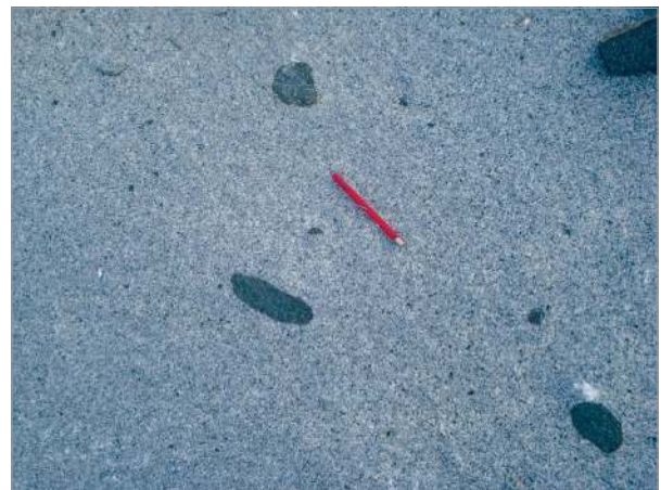
Figura 7. Textura geral dos biotita sienogranitos com a ocorrência de enclaves máficos microgranulares.
