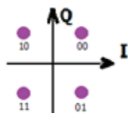
Figura 2.6. Diagrama de constelación QPSK
