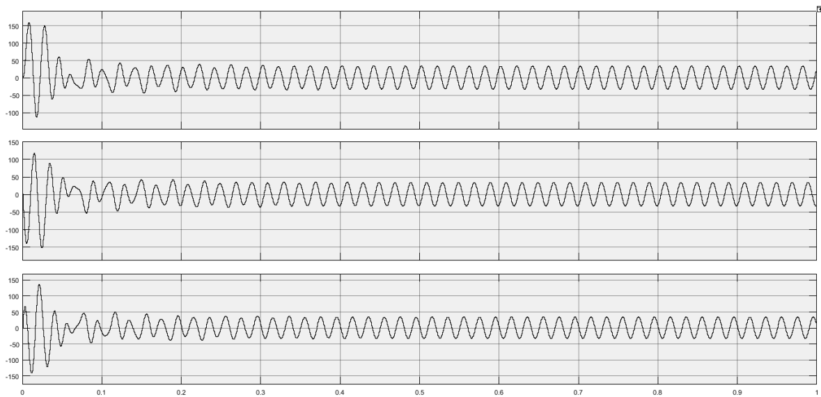
Gambar 15. Gelombang Arus Fasa R, S, dan T Tanpa Filter Dengan Beban Motor Induksi 3 Fasa
