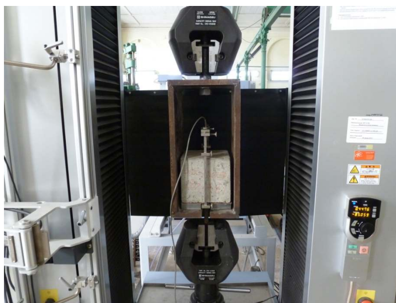
Рисунок 3.1. Экспериментальные исследования сил сцепления арматуры с бетоном
