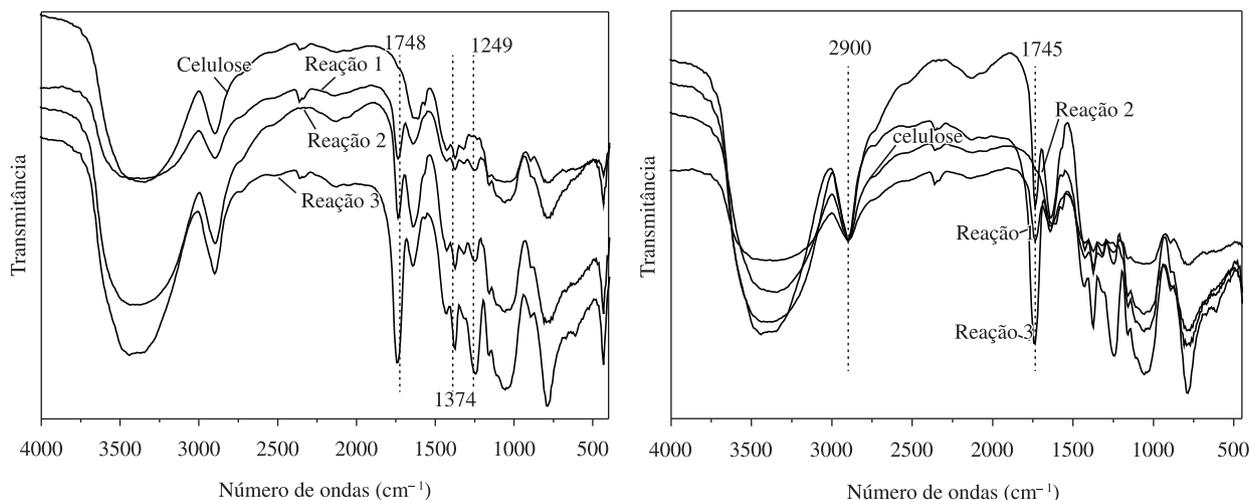
**Figura 1.** (a) Espectros na região do infravermelho não normalizados dos produtos das acetilações obtidos nas reações: sem catalisador (reação 1), utilizando piridina (reação 2) e NBS (reação 3) e (b) espectros normalizados utilizando-se a banda 2900 cm<sup>-1</sup>.
