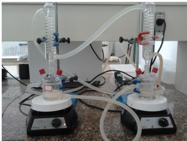
Figura 1 – Aparato experimental utilizado nas reações de transesterificação.
