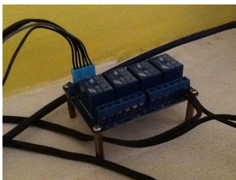
Figura 7 – Chaveamento com relé
