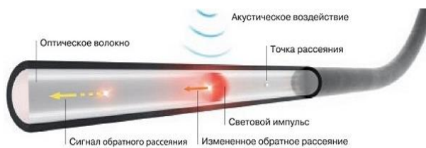
Рис. 1. Принцип действия распределенного акустического зондирования
