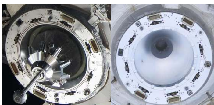
Рис. 6. а) Конфигурация манипулятора SSRMS при причаливании модуля МИМ-1 (данные NASA), б) активный и пассивный стыковочные агрегаты системы «штырь-конус»
