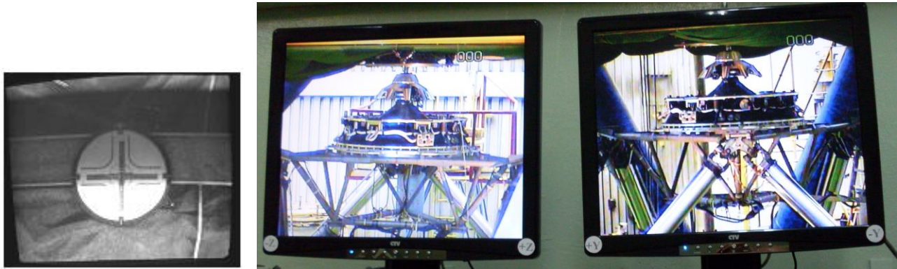
Рис. 8. а) Изображение с прицельной телекамеры при гибридном моделировании причаливания модуля МИМ-1; б) изображения с обзорных телекамер
