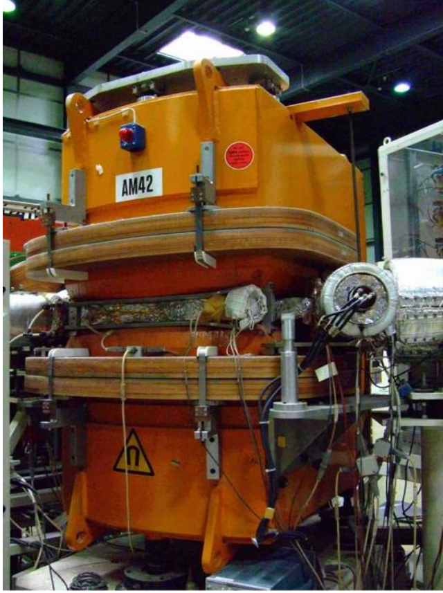
Fig. 30. TSR dipole magnet.
