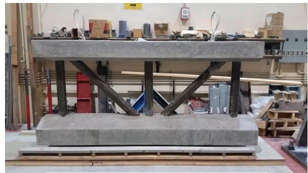
(d) Truss Girder after Casting
