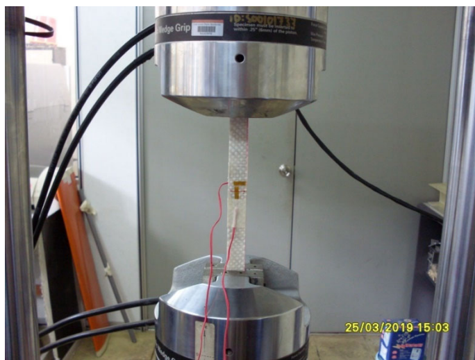
Fig. 3 Tensile Test device
