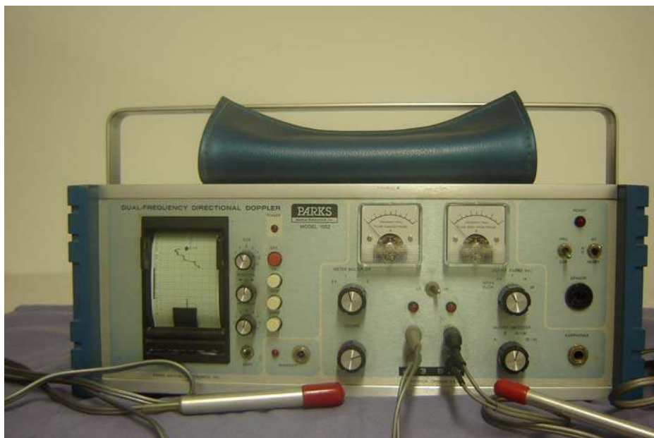
Figura 5 - Aparelho Dual Frequency Directional Doppler Parks Model 1052 utilizado na velocimetria Doppler
