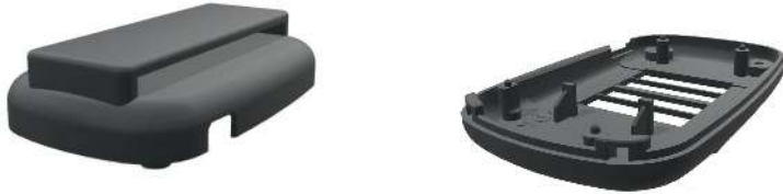
Bild 5.13: Entworfenes CAD-Model des Sensorgehäuses
