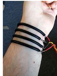
d) Variante 4: Leitfähiges Elastomer
