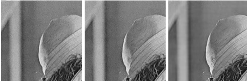
Рис. 2. Сжатое изображение с использованием DHT (слева), DCT (посередине), DWHT (справа) для K = 93\%
