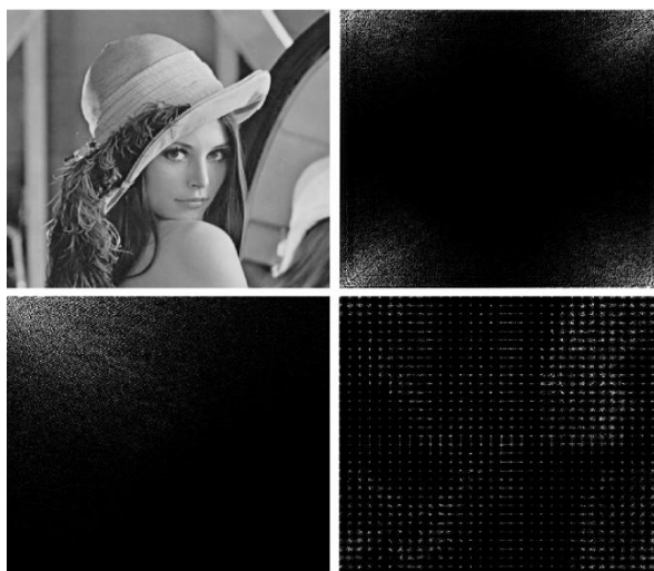
Рис. 1. Исходное изображение (слева сверху), DHT (справа сверху), DCT (слева снизу) и DWHT (справа снизу) Fig. 1. Original image (top-left), DHT (top-right), DCT (bottom-left) and DWHT (bottom-right)
