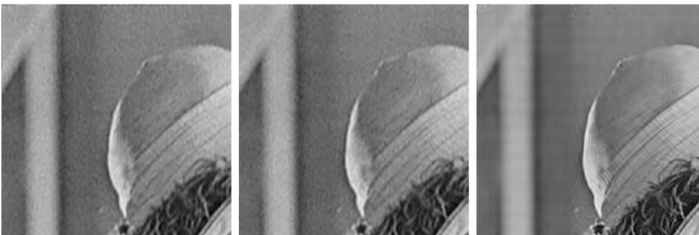
Рис. 3. Сжатое изображение с использованием DHT (слева), DCT (посередине), DWHT (справа) для K = 95\%
