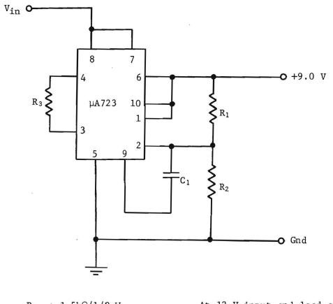
$\begin{array}{rrrr} R_1 & : & 1.5 k \Omega / 1 / 8 \ W \\ R_2 & : & 6.8 k \Omega / 1 / 8 \ W \\ R_3 & : & 1.5 k \Omega / 1 / 8 \ W \\ C_1 & : & 100 \ pF \\ V_{1n} & : & 12 \ V \ \pm \ 5\% \end{array}$
