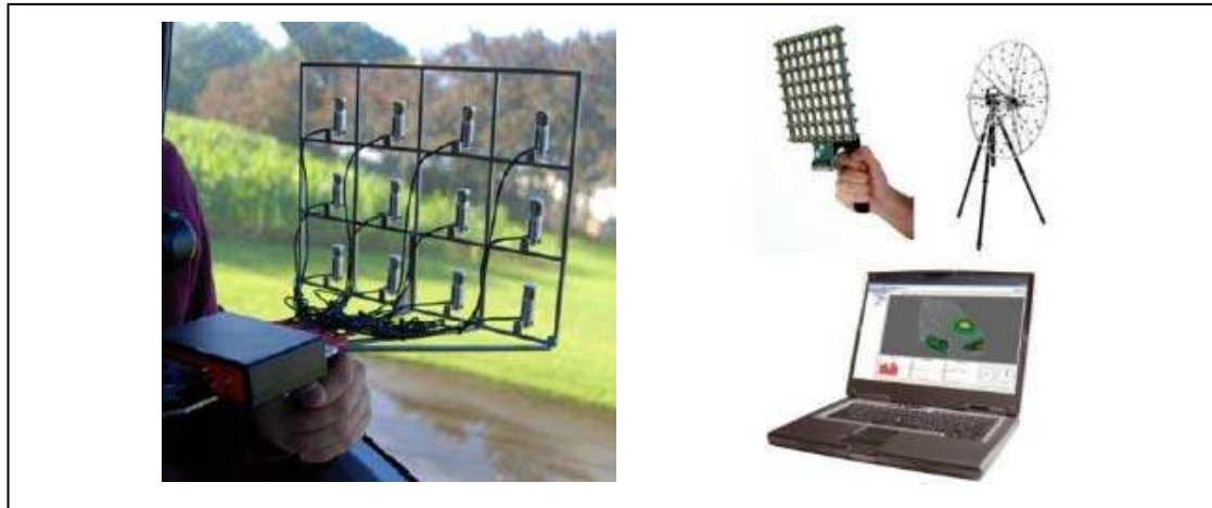
Figura 2.29.- Dos arrays de transductores de tecnología diferente utilizados para el estudio de campos sonoros. A la izquierda construido con sensores microflow y a la derecha con micrófonos.
