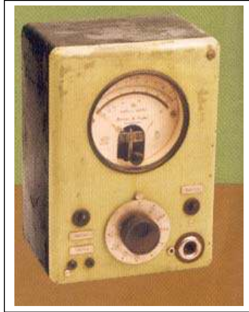
Figura 2.17.- Primer equipo portátil para medida de sonido capaz de hacer espectros en frecuencia.
