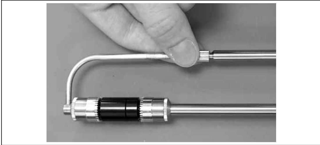
Figura 2.21.- Detalle de los micrófonos y del separador de una sonda p-p.
