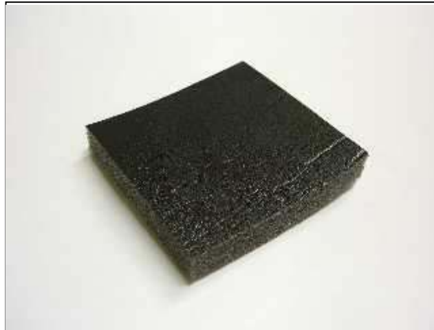
Figura 5.3. - Material aislante utilizado en el forrado del interior de la caja de ensayo.
