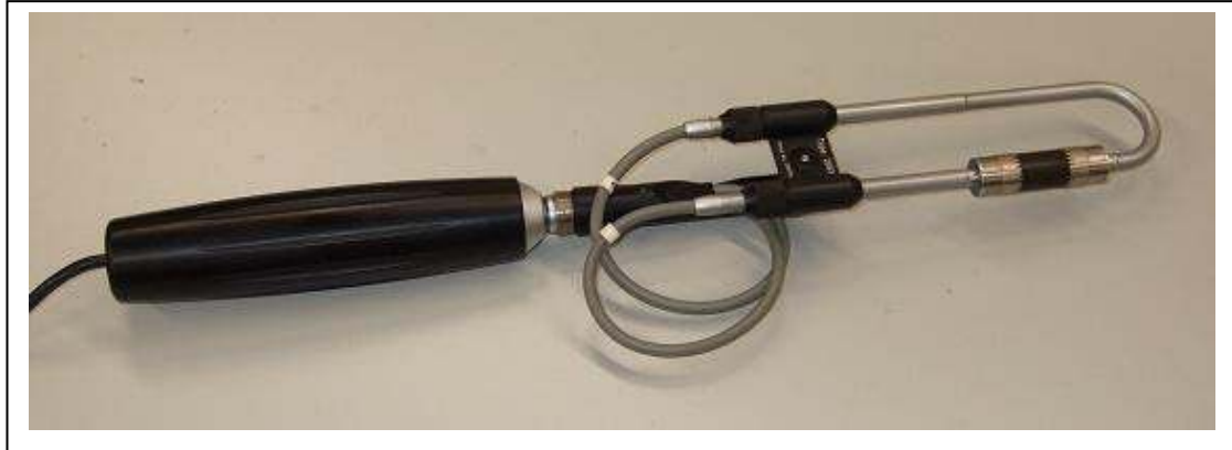
Figura 5.7.- Sonda de intensidad modelo 3595 de B&K utilizada en la realización de las medidas.
