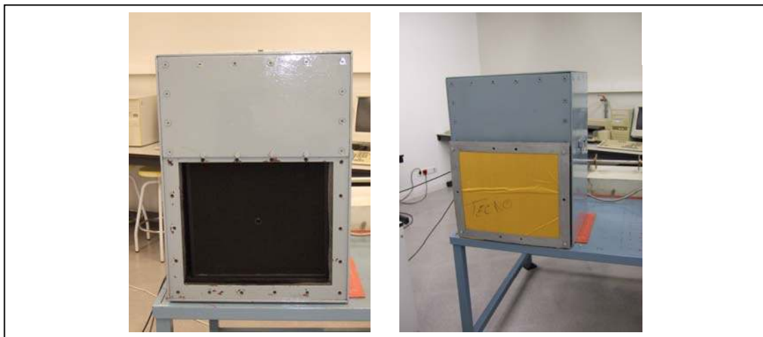
Figura 5.24. - A la izquierda la caja de ensayo sin probeta y a la derecha con una probeta de lana de roca sujeta por medio de un marco de acero inoxidable.
