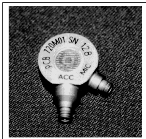
Figura 2.23.- Sonda del tipo p-u diseñada por Paul C. Janzen, combina un acelerómetro y un micrófono de forma compacta.
