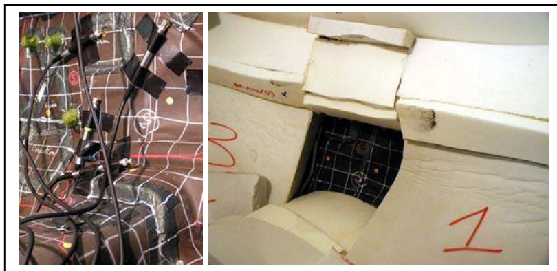
Figura 2.26. A la izquierda varias sondas del tipo p-u miden la velocidad normal a una superficie de un automóvil. A la derecha el método de la ventana utilizado para medir la misma superficie con una sonda del tipo p-p.
