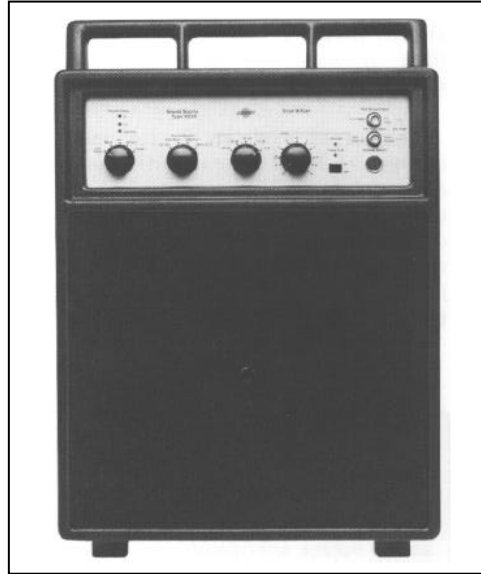
Figura 5.5. Fuente sonora 4224 de la firma comercial Brüel & Kjaer empleada en los ensayos.
