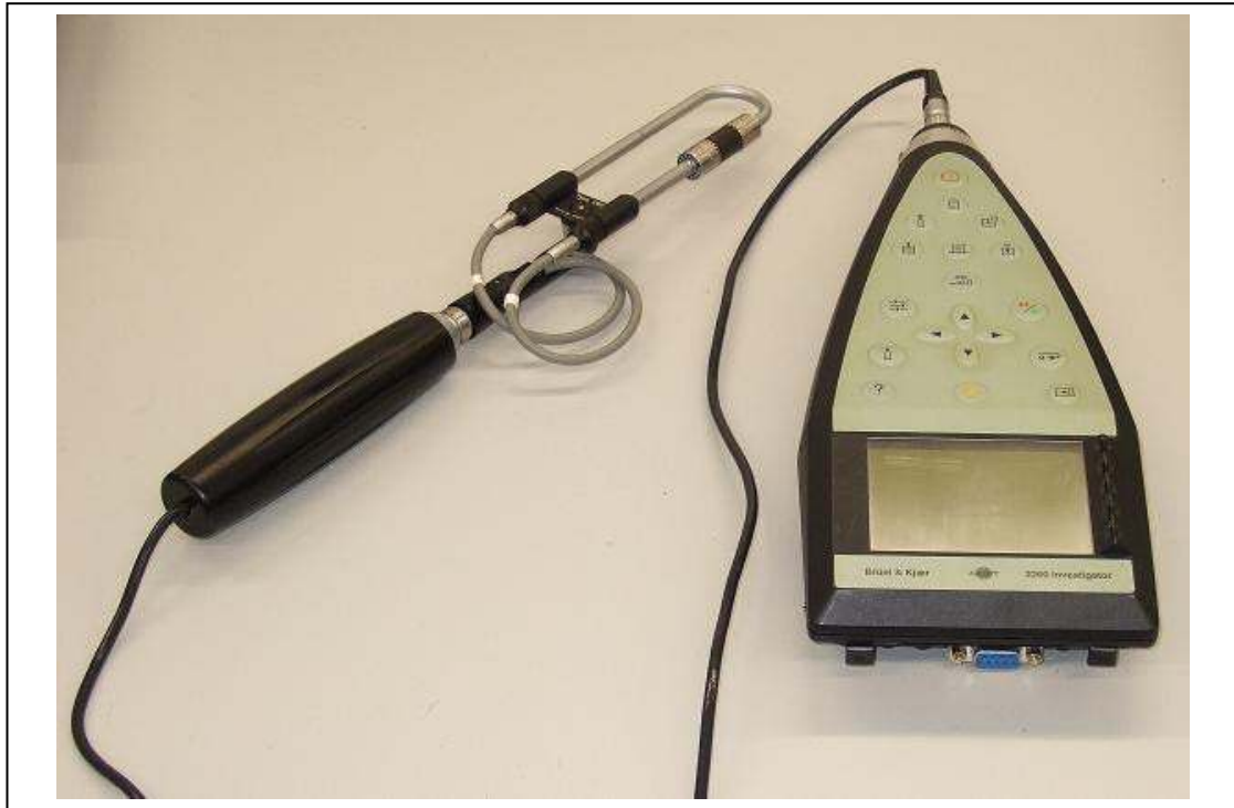
Figura 5.9.- Sonómetro modelo 2260 Investigator de B&K, con la sonda de intensidad acoplada.
