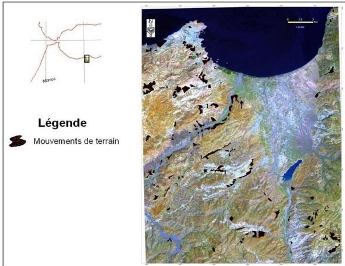
**Figure 3 :** Cartes d'instabilité de terrains extraites par télédétection
