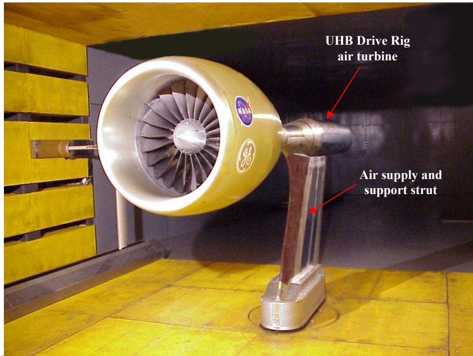
a) Fan module with flight-type inlet, nacelle and fixed area fan nozzle
