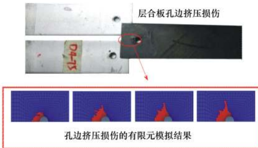
图4 D4 试验件失效模式
