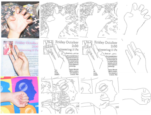
(a) Original image (b) Canny (Thre.=1) (c) Canny (Thre.=0.3) (d) Depth edges
