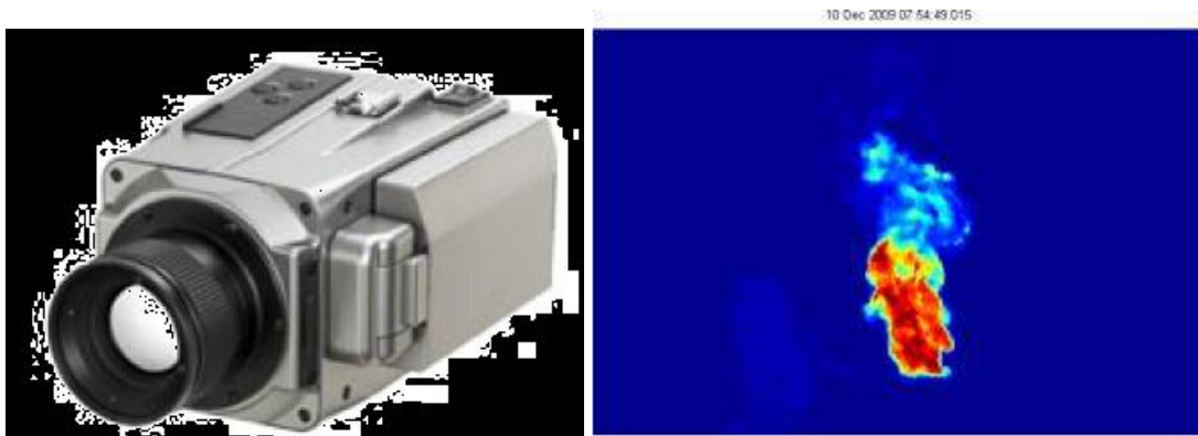
Figure 67 Thermal Imager and a LNG pool fire image.
