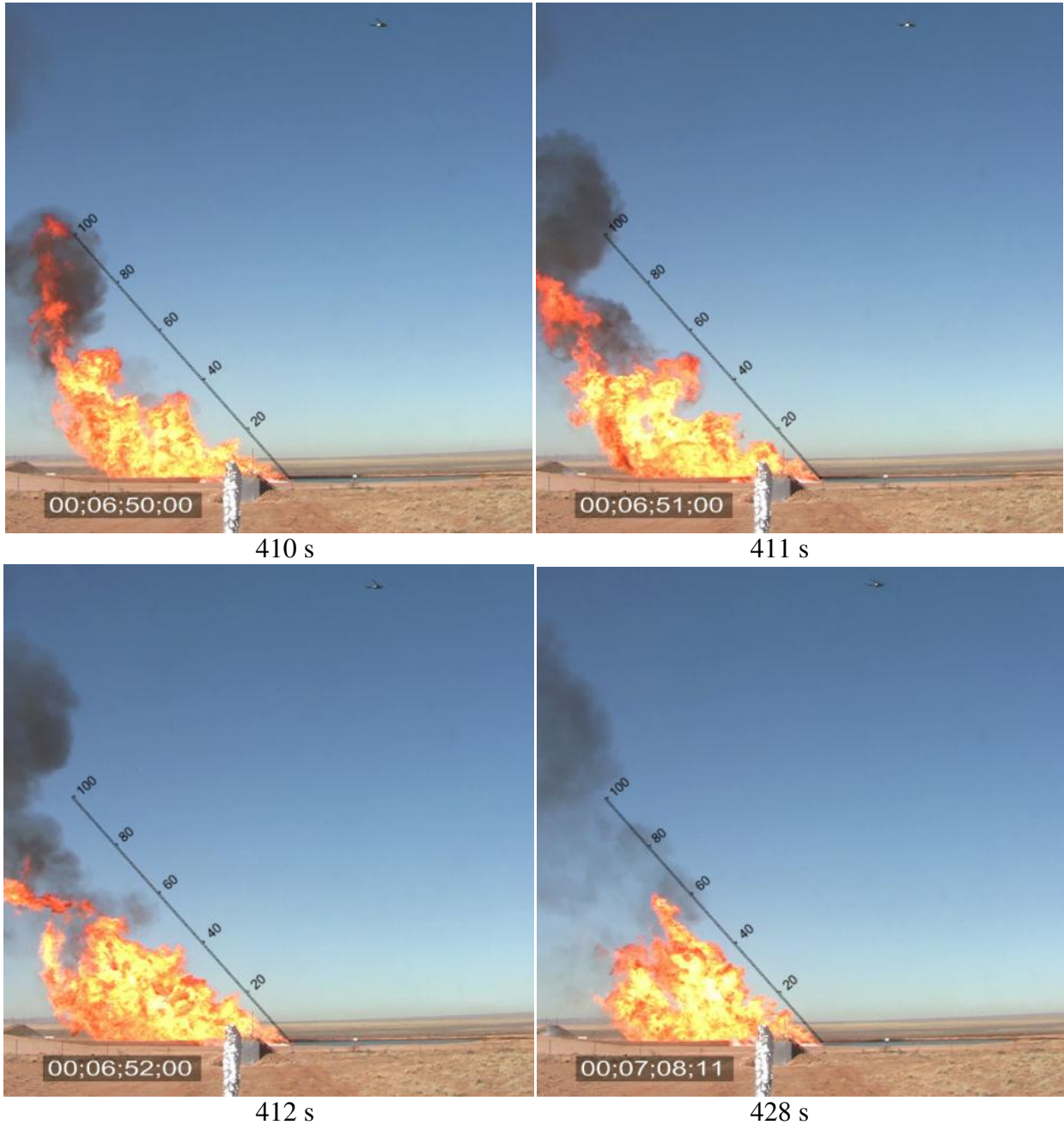
Figure 125 Flame tilt in LNG Test 1.
