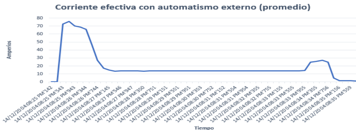
Figura 23. Gráfica de corriente de arranque con automatismo
