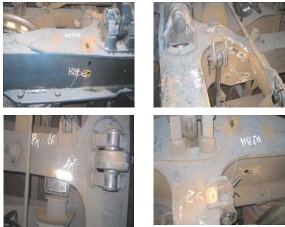
Рис. 6. Місця встановлення тензорезисторів
