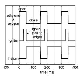
Fig. 5 Sequence B (mixture : helium = 1 : 2)
