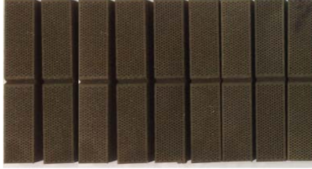
Şekil 9. KRZ gözenek yapısına sahip ve farklı imalat parametreleri ile üretilen çentik darbe numuneleri (Impact test specimens with KRZ type porous scaffold and produced with different manufacturing parameters)
