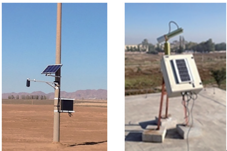
图1 包头场沙地自然场景及部署的地表和大气特性自动观测系统(上图:沙地自然场景;下左图:地表反射光谱自动测量系统;下右图:全自动太阳光度计)
