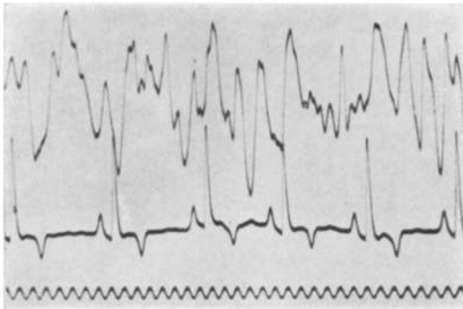
Abb. 2. Dieselbe Hündin wie in Abb. 1 und die gleiche cerebrale Ableitung. Doppelspulg galvanometer von Siemens und Halske. Zu oberst die vom Großhirn abgeleitete Kurve; darunter das Elektrokardiogramm, abgeleitet mit unter die Haut geschobenen amalgamierten Zinkstäbchen; unten die Zeit in \frac{1}{10} Sekunden. Kondensation.
