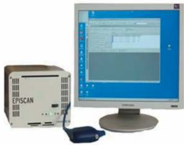
Ryc. 1. Ultrasonograf wysokich częstotliwości Episcan (Longport Int., USA) z głowicą mechaniczną 50 MHz
