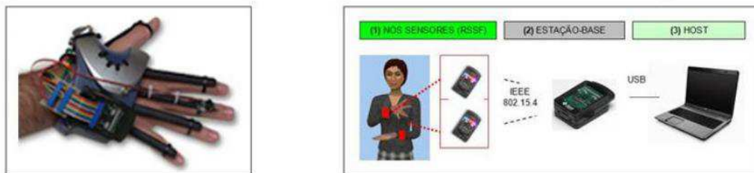
Figura 6 – Luva e arquitetura de comunicação SensorLibras [Tavares et al, 2010].
