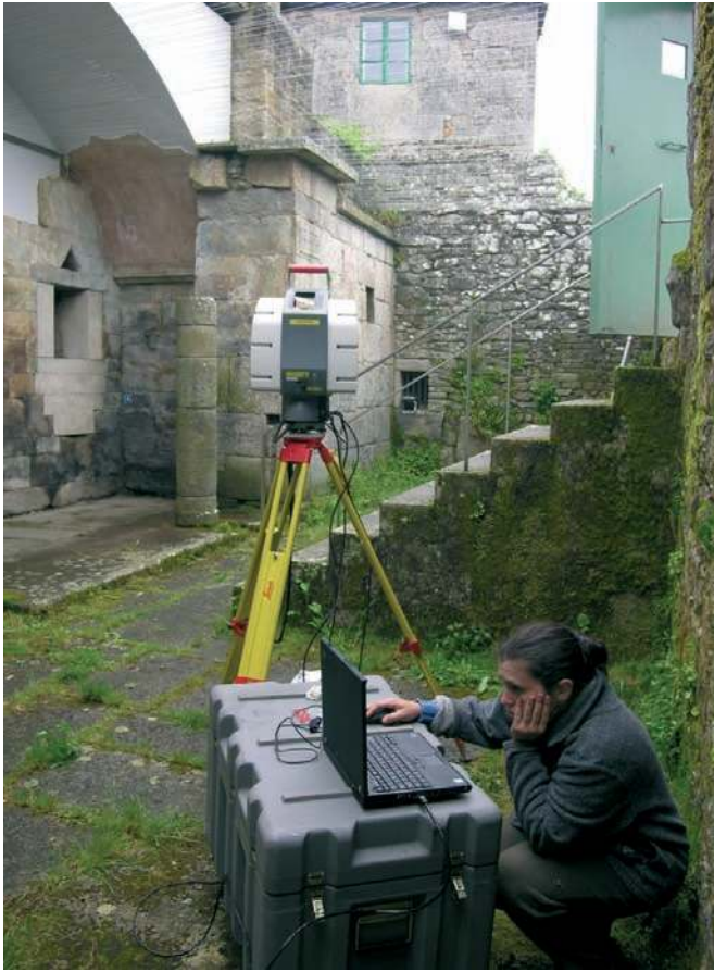
Fig. 2. Instalación en campo del escáner (Santa Eulalia de Bóveda, Lugo)
