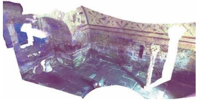
Fig. 7. Detalle de la nube de puntos de uno de los escaneos en el aula. Para realizar este trabajo se necesitaron 4,5 días de registro en campo, obteniendo una base de datos compuesta por más de 50 millones de puntos
