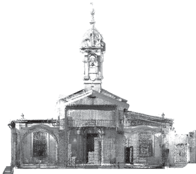
Fig. 1. Vista de una nube de puntos 3D del edificio de San Fiz de Solovio (Santiago de Compostela). La vista conjunta de todos los puntos transmite visualmente una imagen modelizada del edificio en 3D, aunque se compone únicamente de millones de puntos singulares
