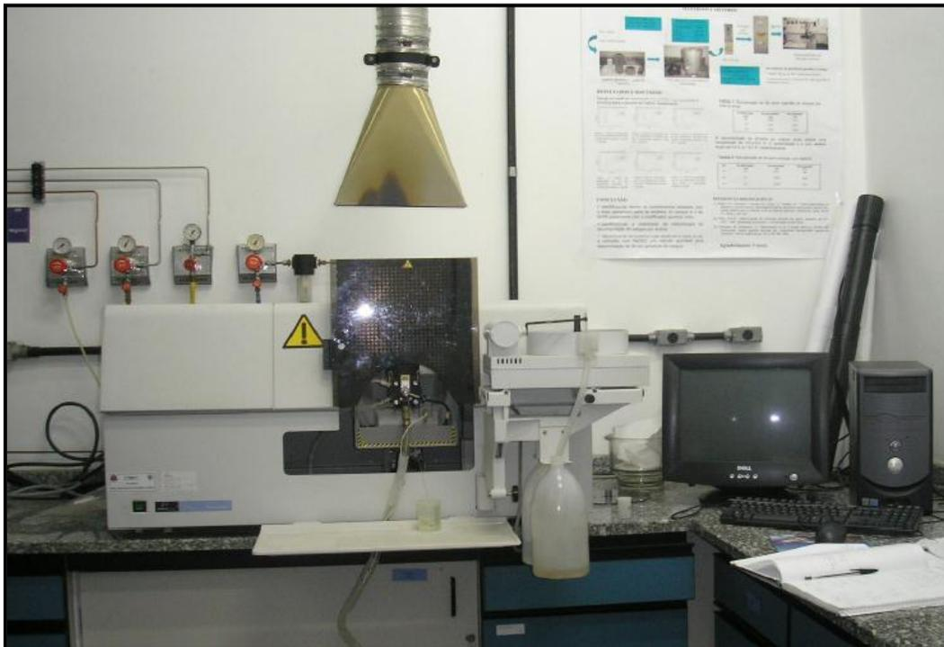
**Figura 10** – Espectrômetro de absorção atômica, com módulos de atomização por chama e por forno de grafite, utilizado na determinação de elementos metálicos
