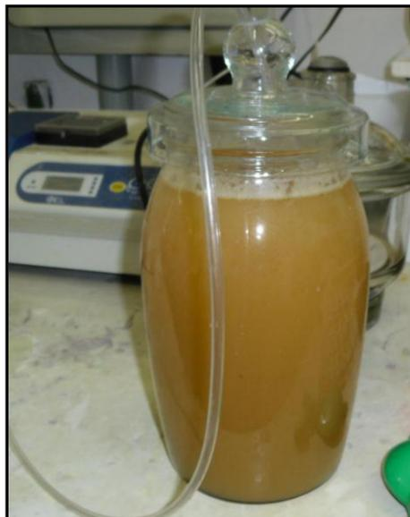
**Figura 13** – Lodo ativado utilizado no tratamento biológico
