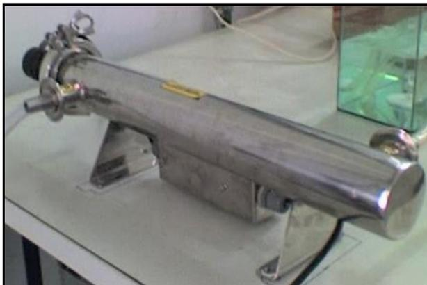
**Figura 11** – Reator tubular utilizado para o tratamento fotoquímico
