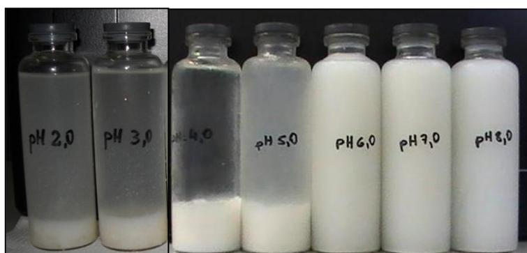
**Figura 17** – Coagulação da caseína no efluente lácteo: efluente com acentuada precipitação em pH ácido, após quatro minutos de sedimentação
