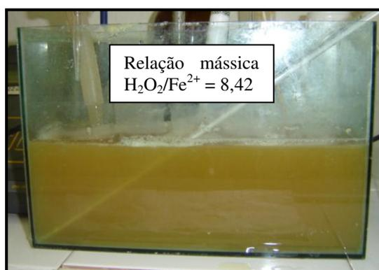
**Figura 19** – Experimento com a adição das soluções de  $\text{H}_2\text{O}_2$  e  $\text{Fe}^{2+}$  com uma relação mássica de 8,42, durante a reação fotocatalítica
