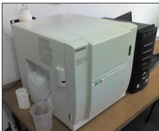
**Figura 15** – Analisador de carbono orgânico total da Shimadzu, modelo TOC-VCPH
