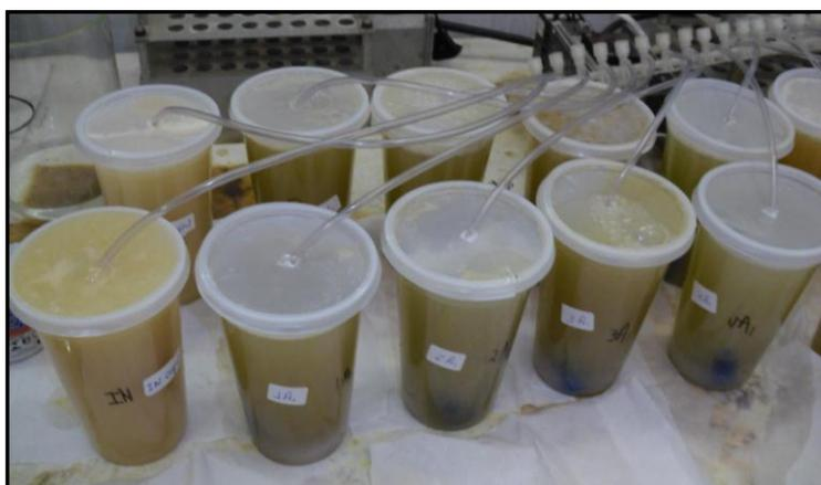
**Figura 14** – Sistema aerado utilizado no tratamento biológico
