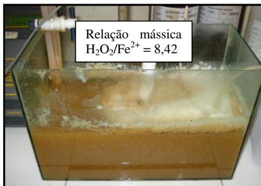
**Figura 20** – Experimento com a adição inicial total da solução de  $\text{Fe}^{2+}$  e a adição da solução de  $\text{H}_2\text{O}_2$  durante a reação de oxidação, com relação mássica de 8,42.
