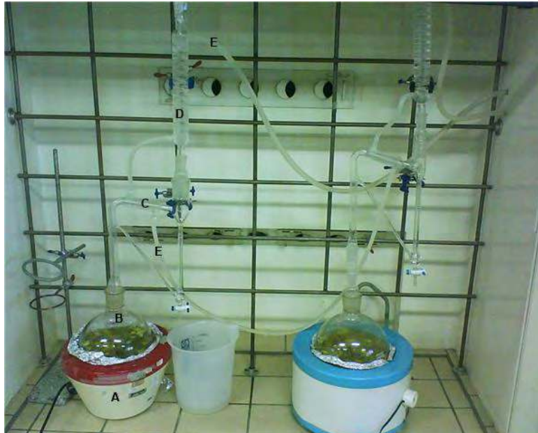
Figura 1. Sistema de hidrodestilação utilizado na extração de óleos essenciais. a) Manta aquecedora, b) balão volumétrico, c) clevenger, d) condensador e e) mangueiras de aferrecimento.
