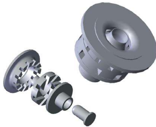
Bild 3.6 Drallerzeuger Typ B, Drallerzeugung mittels tangentialer Kanäle
