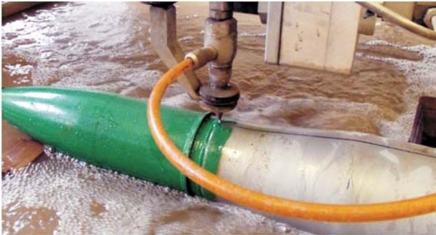
Figure 2 Experimental cutting of anti tank bullet with AWJ Slika 2. Eksperimentalno rezanje protutenkovskog metka s abrazivnim vodenim mlazom
