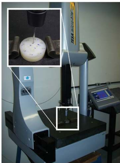
Figura 4. Medição de circularidade: a) Máquina de medir por coordenadas Tesa Micro-hite 3D; b) diâmetro máximo do furo.
